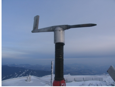
Slika 3.6: Pitotova cev z vetrokazom (vir: www.accuweather.com ).
