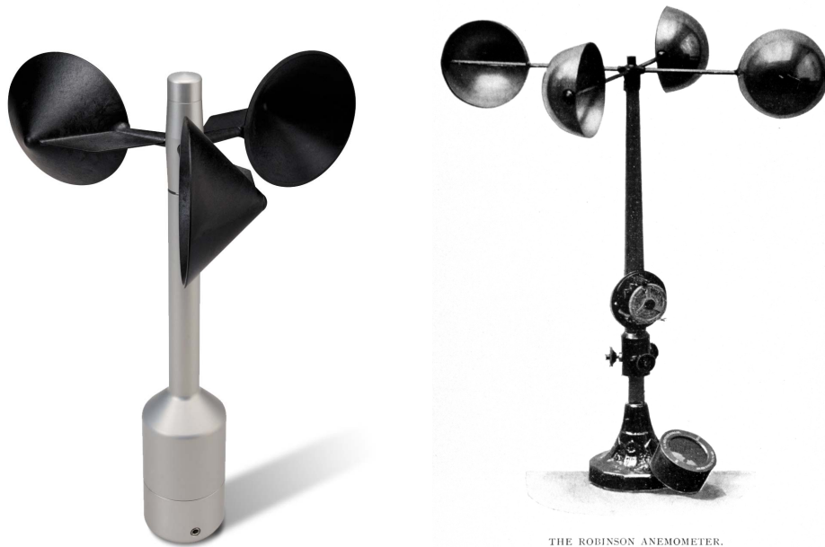
Slika 3.2: Levo: 3-šalčni anemometer (vir: www.directindustry.com ), desno: 4-šalčni anemometer, tudi Robinzonmeter, kot ga je leta 1846 skonstruiral irski fizik Thomas Romney Robinson (vir: www.wikipedia.org ).
