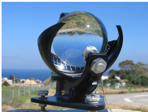
Slika 6.1: Heliograf (Vir: www.kuriositas.com ).
